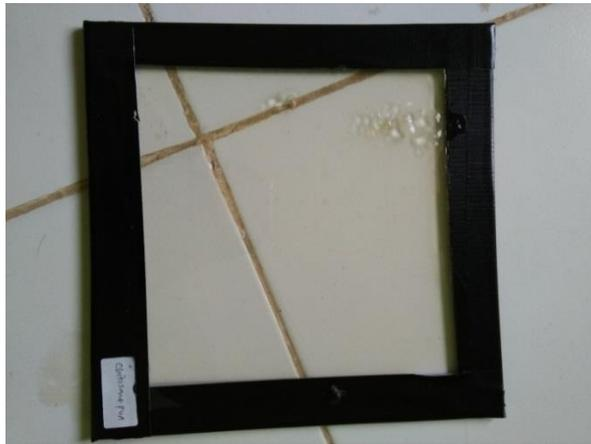
**Gambar 2. Larutan chipo yang dituangkan di atas akrilik untuk dibuat lapisan tipis.**
