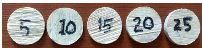
**Gambar 2.** Spesimen Uji Redam/Akustik
